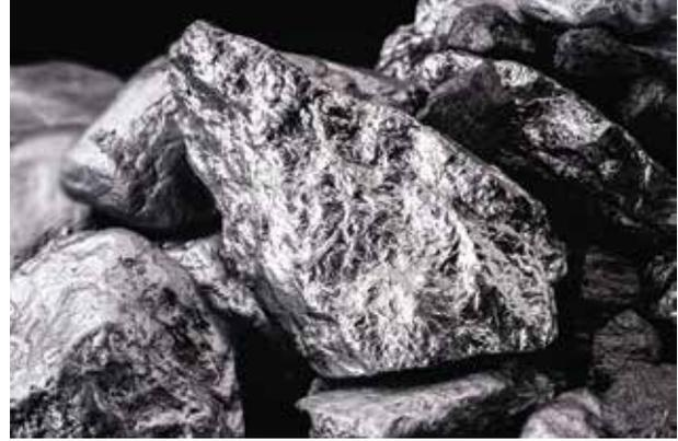
**الليثيوم:** وهو فلزٌ خفيفٌ لين، كثافته منخفضة، ولا يوجد حرّاً في الطبيعة. لذلك، يجب حفظه في محلولٍ زيتي معدني. وهو أهم الفلزات لصناعة أجود البطاريات الكهربائية. ومن مميزات بطارية الليثيوم؛ صغر حجمها، وخفة وزنها، وسرعة شحنها، وبطء تفريغها، وعمرها الزمني الطويل. ولليثيوم استخدامات أخرى في صناعة أدوية الأعصاب، وصناعة الشحوم والزجاج.
