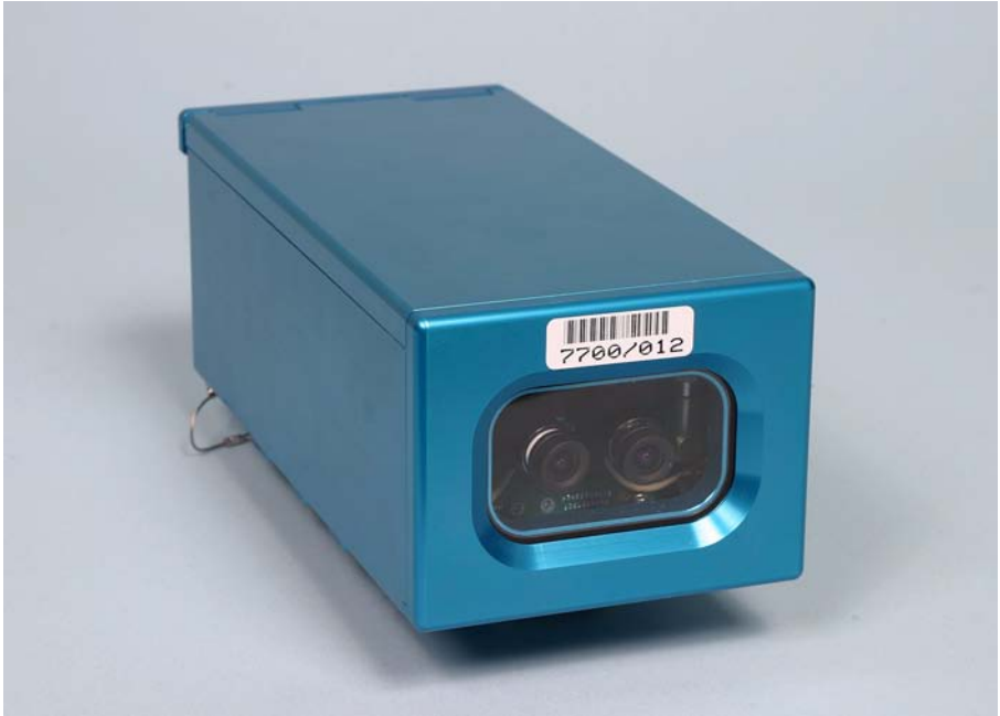
FIG. 31. HDIS portable surveillance unit.
