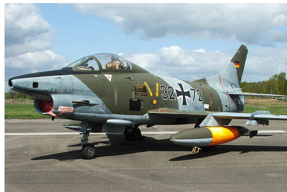
Un altro aereo eccellentemente conservato nei suoi colori originali, il G.91R/3 con i suoi 2 cannoni da 30mm e i 4 punti d'aggancio
