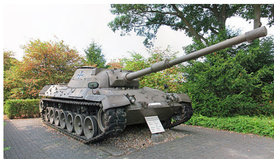
Il Leopard 1 prototipico, mostra la sua 'prima' edizione con la torre di fusione 'nuda', priva di ogni accessorio. Cingolatura a parte, non appariva molto diverso da un T-62
