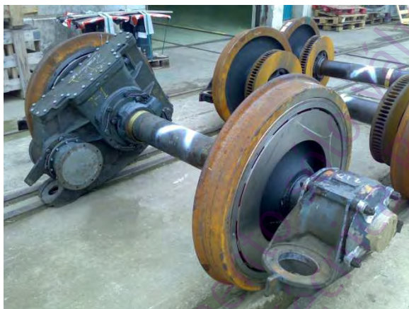
Figura 1-42. Ejes motores – Transmisión por engranajes.
