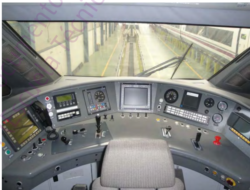
Figura 1-11. Cabina de conducción.
