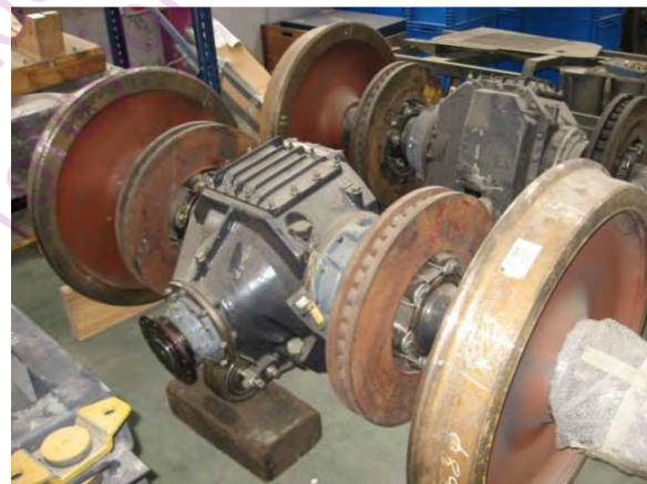
Figura 1-43. Ejes motores – Transmisión por cardan.
