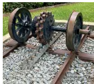
Figuras 1.17, 1.18 y 1.19. Tren cremallera. ↖ A la izquierda se observa la cremallera o tercer carril dentado entre los carriles; ↑ en el centro, el detalle de la cremallera fija; ↗ a la derecha, cómo engrana la rueda dentada del tren con la cremallera fija, en los tramos en que hay cremallera. 📷 FGC
