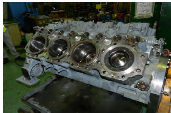
Figura. 3-9 S/311 Bloque motor con camisas y cilindros montados
