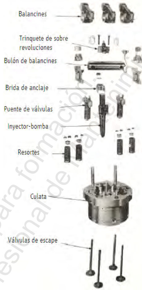
Figura. 3-15 Despiece de la culata
