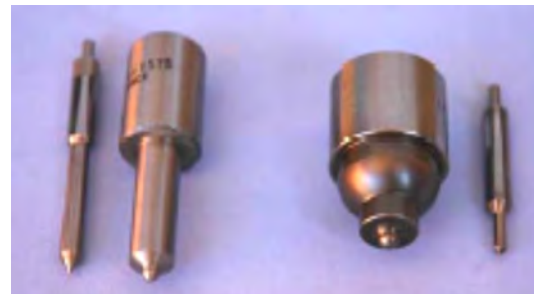
Figura. 3-44 Toberas del inyector con sus agujas. Conjuntos inseparables
