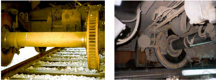
Figura. 2-62 Discos de freno de coche de viajeros (izquierda) y de autotren (derecha)
