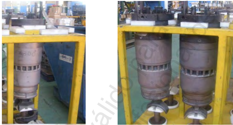
Figura. 3-13 Conjuntos de equipos de potencia
