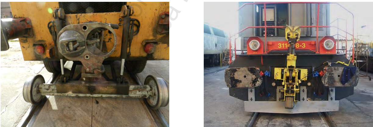
Figura. 5-32 Enganche auxiliar para maniobras. En locotractor (izquierda). En locomotora (derecha)
