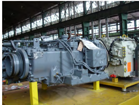
Figura. 4-5 Conjunto de Motor diésel y Transmisión hidráulica
