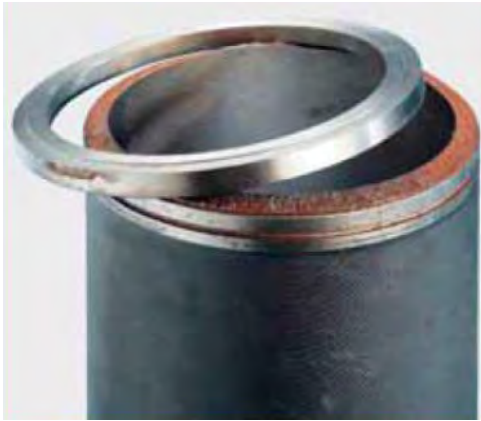
Figura. 5-7 Rotura de collarín en cilindro por fallo de montaje
