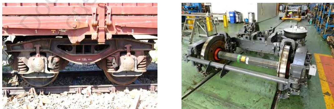
Figura. 3-2 Bogie portante de vagón de mercancías (izquierda) y de vehículo autopropulsado (derecha)
