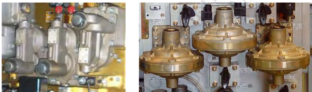
Figura. 5-23 Relé de freno en equipos de Knorr (izquierda) y de Faiveley (derecha).
