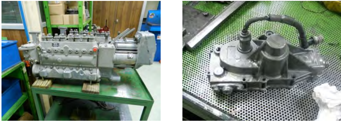
Figura. 5-31 Bomba en línea con actuador magnético (izquierda) y Actuador para control de cremallera (derecha)
