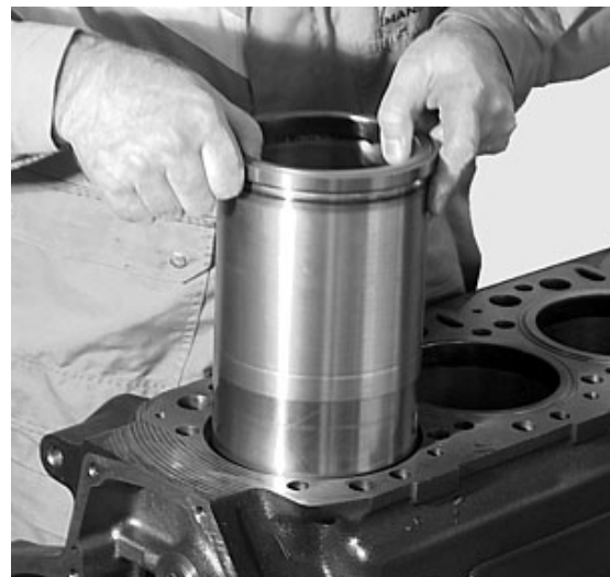
Figura. 5-6 Montaje de cilindro
