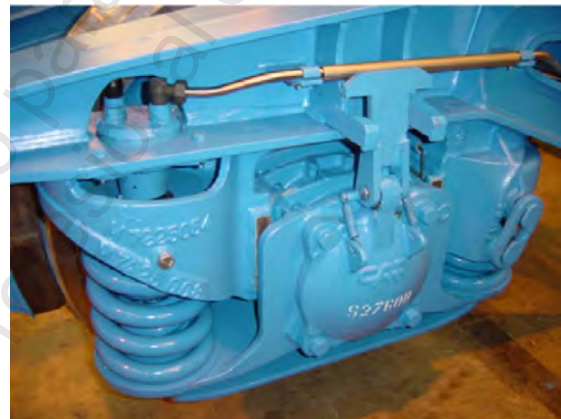
Figura. 3-15 Bogie y-21 con válvula de pesada
