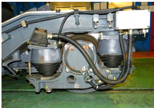
Figura. 2-45 Ejemplos de unión goma/caucho y metal
