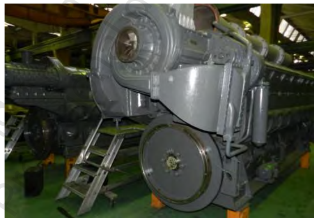
Figura. 3-25 Posición del turbo-compresor en el MD
