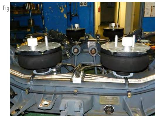
Figura. 2-55 Suspensión por balonas neumáticas
