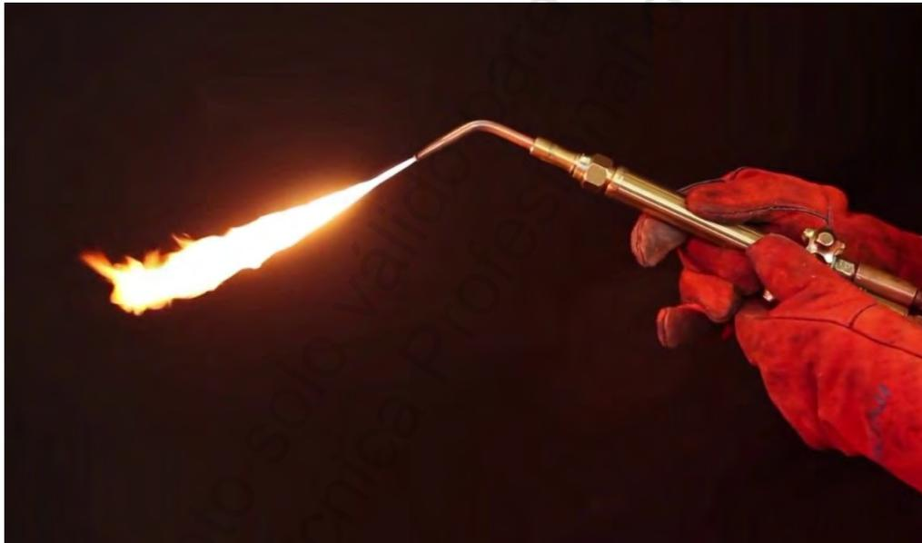
Figura. 6-1 Encendido de equipo oxicorte
