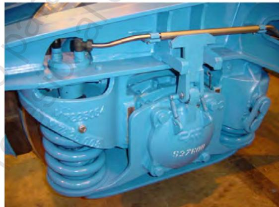
Figura. 3-15 Bogie y-21 con válvula de pesada
