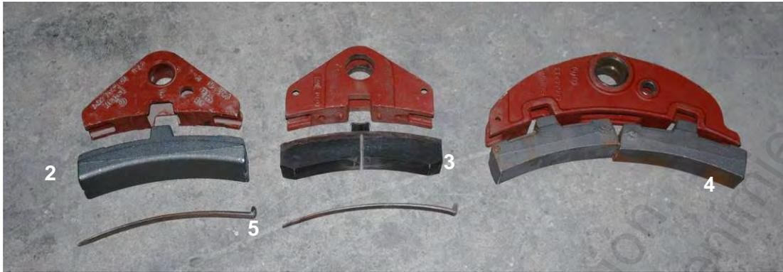
Figura. 2-59 Tipos de zapatas. 1.- Portazapatas 2.- Zapata de fundición 3.- De compuesto 4.- Doble 5.- Espadín
