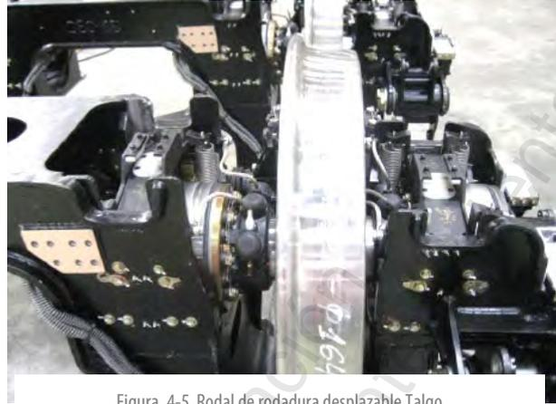
Figura. 4-5 Rodal de rodadura desplazable Talgo
