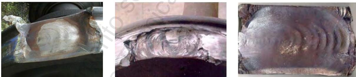
Figura. 9-29 Fisuras internas por defectos profundos
