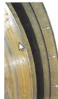
Figura. 9-32 Desplazamiento de material
