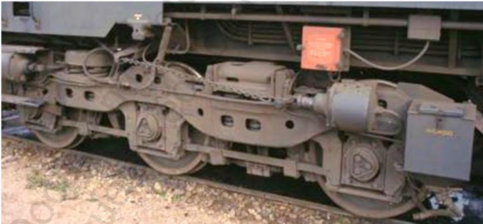
Figura. 2-61 Timonería de freno de locomotora con cadenas
