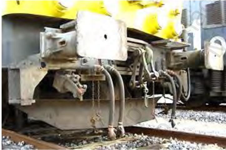
Figura. 5-33. Vehículo con traviesa fusible
