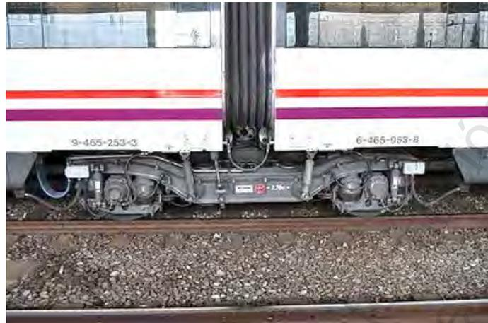
Figura. 3-7 Bogie compartido de vehículo autopropulsado
