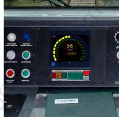
Figura. 4-13 Actuador de sistema SIBI
