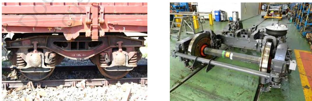
Figura. 3-2 Bogie portante de vagón de mercancías (izquierda) y de vehículo autopropulsado (derecha)
