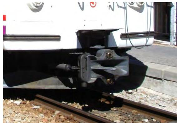
Figura. 5-28 Enganche mecánico con acoplamiento neumático
