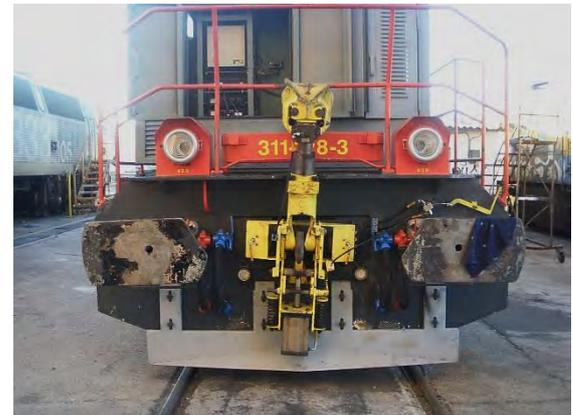
Figura. 5-32 Enganche auxiliar para maniobras. En locotractor (izquierda). En locomotora (derecha)
