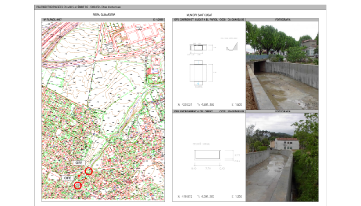
Fitxa realitzada a partir de la visita de camp, on s'ha col·locat mapa de situació, coordenades, fotografia i croquis de l'estructura. En la figura estructures de la riera Guinardera a Sant Cugat del Vallès.
