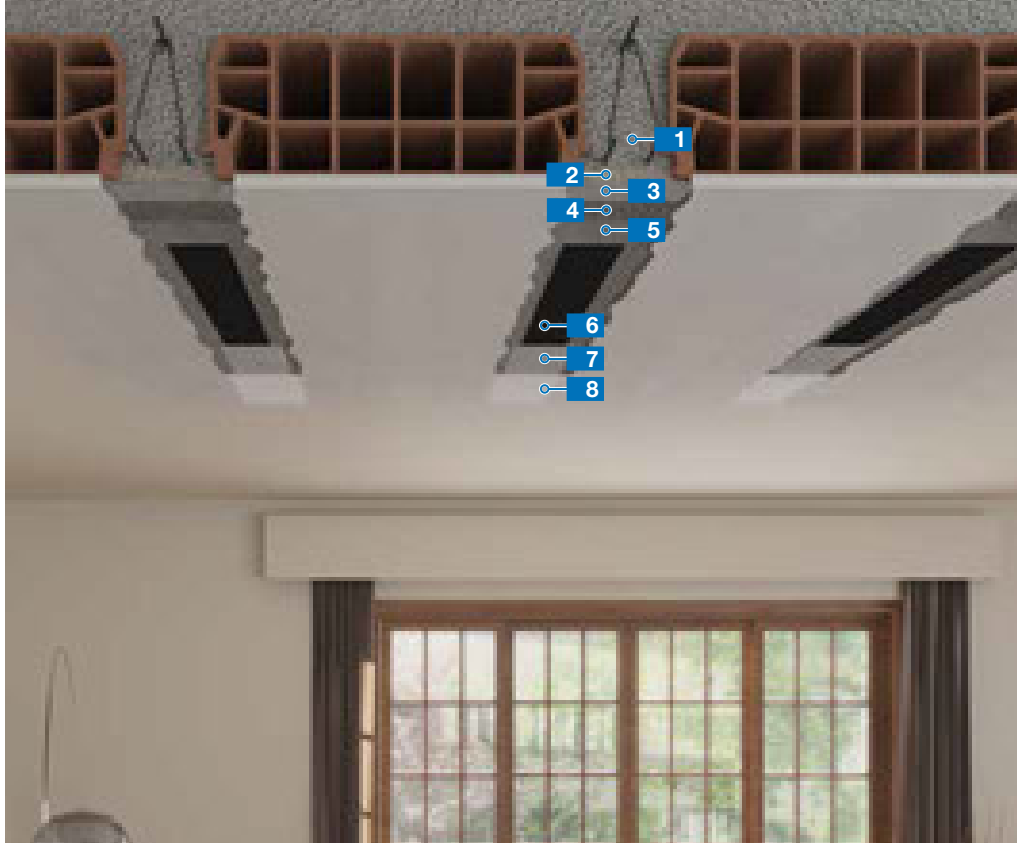
Sistema per il rinforzo a flessione di solai in latero-cemento System for flexural strengthening of brick-cement floor beams
