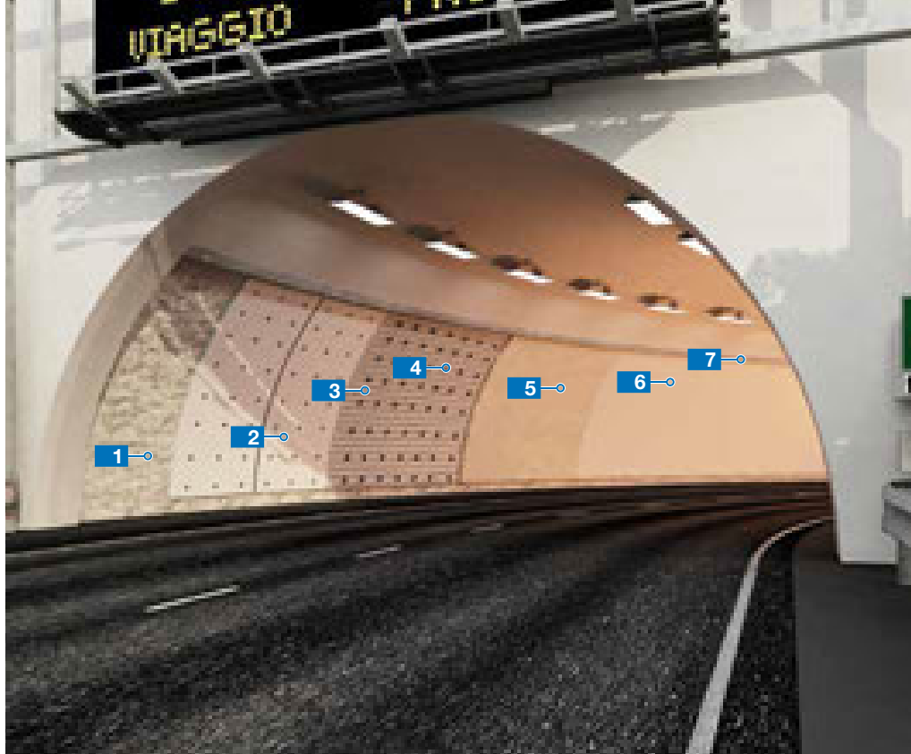
Sistema di drenaggio e risanamento dei piedritti in galleria System for draining and repairing tunnel piers
