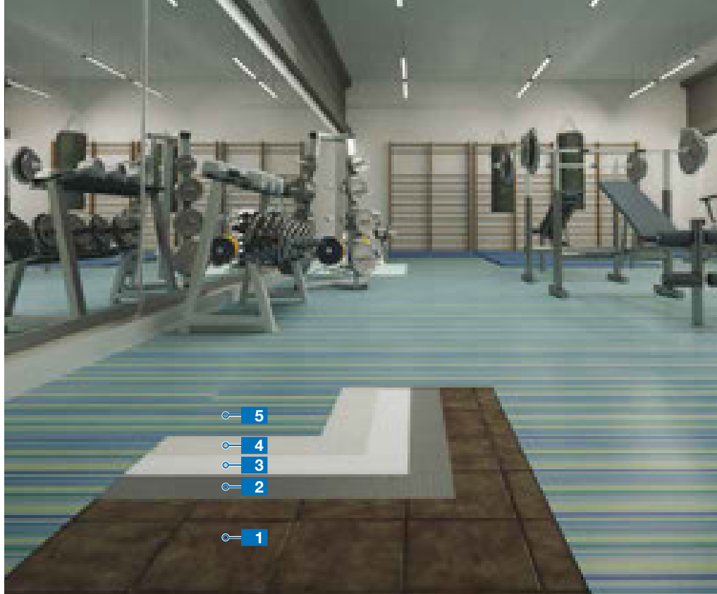
Posa di PVC su vecchie piastrelle ceramiche Installation of PVC on old ceramic tiles
