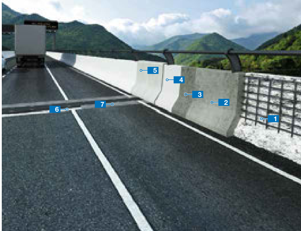
Ripristino di New Jersey e di giunto autostradale Repairing New Jersey crash barriers and joints in motorways
