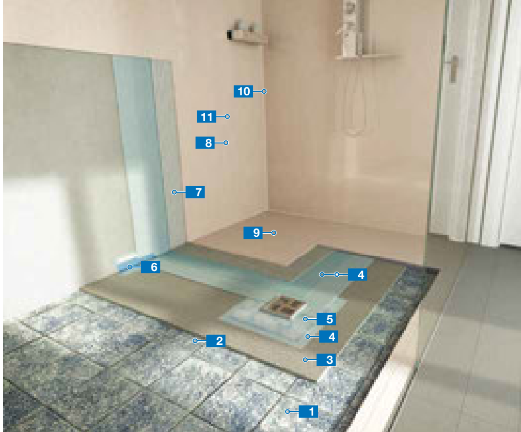
Rifacimento dei bagni con sistema per l'impermeabilizzazione e la posa di mosaico vetroso Renovation of bathrooms with a system for waterproofing and installing glass mosaics
