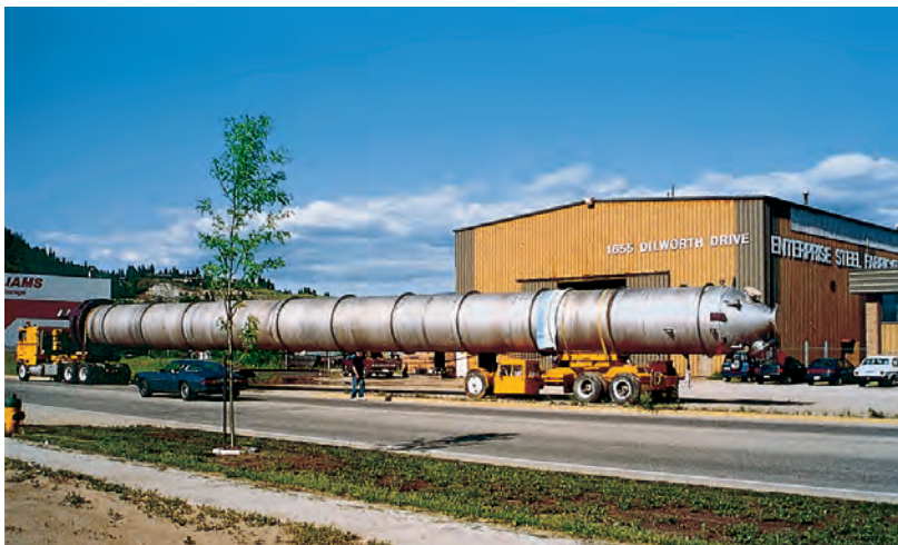
2205 酸素脱リグニン化学反応装置(Enterprise Steel Fab社, Kalowna, Prince George, British Columbia, Canada) (出典：Outokumpu社)
