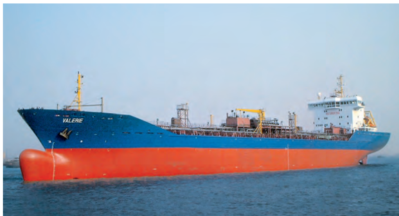
2205ステンレス鋼製タンクを搭載したケミカルタンカー(出典：ArcelorMittal社)
