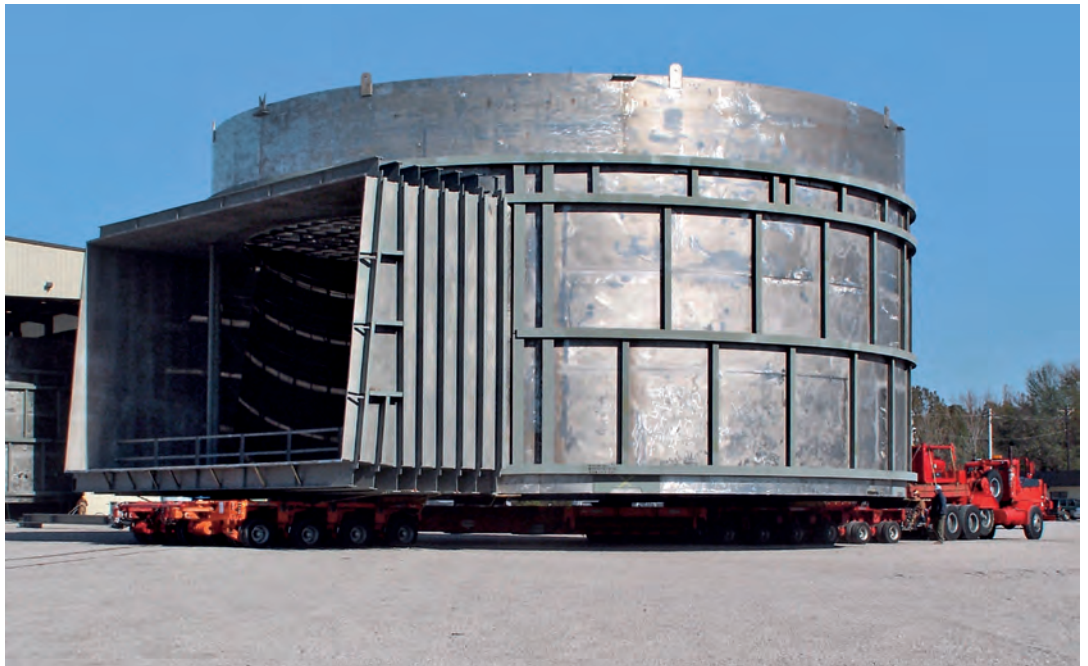
2205ステンレス鋼を使って加工した排煙脱硫ユニット (出典：ArcelorMittal社)
