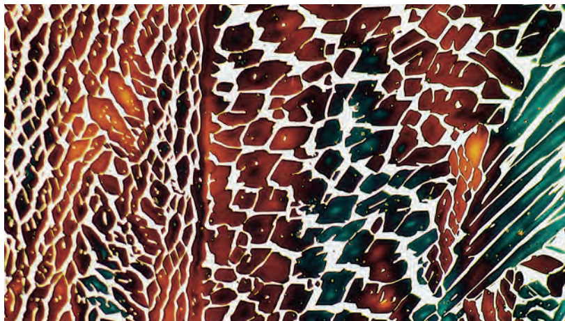
2205二相鋼溶接金属の金属組織 500倍 (出典：Lincoln Smitweld bv社)
