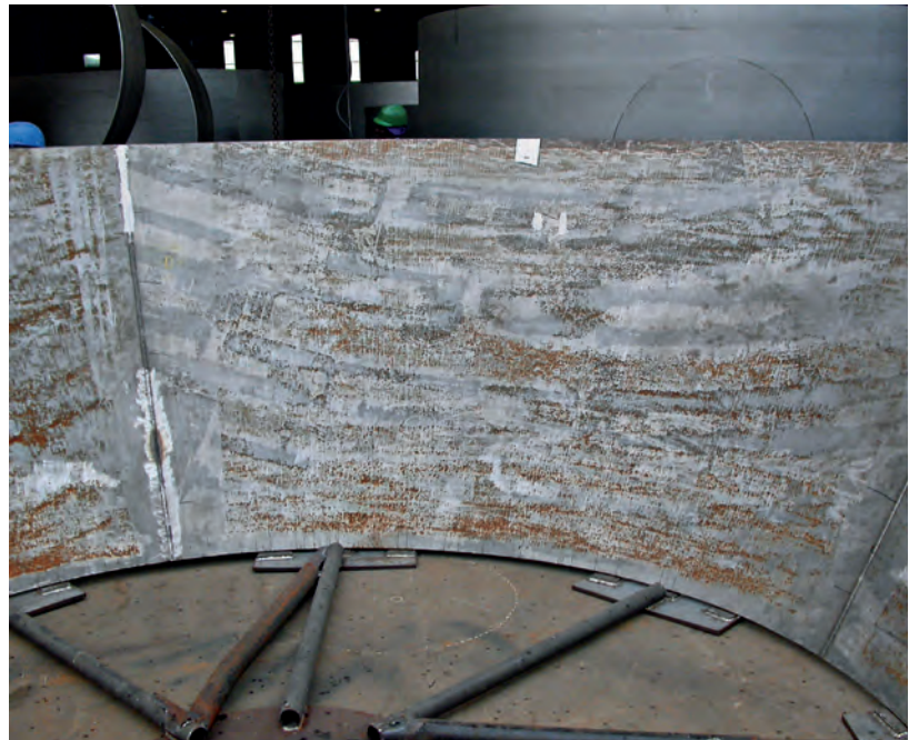
ロール成形二相鋼厚板の加工における埋込み鉄 (出典：Gary Carinc、TMRステンレス社)
