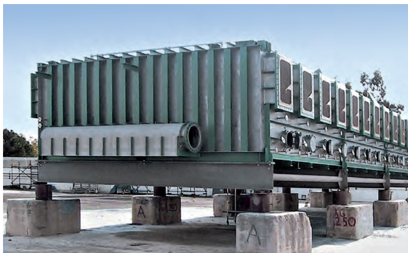
二相鋼S32101およびS32205を使用して建設された多段階フラッシュ海水淡水化ユニット (出典：Outokumpu社)
