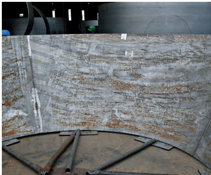
Contaminazione ferrosa nella fabbricazione per laminazione di acciai inossidabili duplex (Fonte: Gary Carinci, TMR Stainless)
