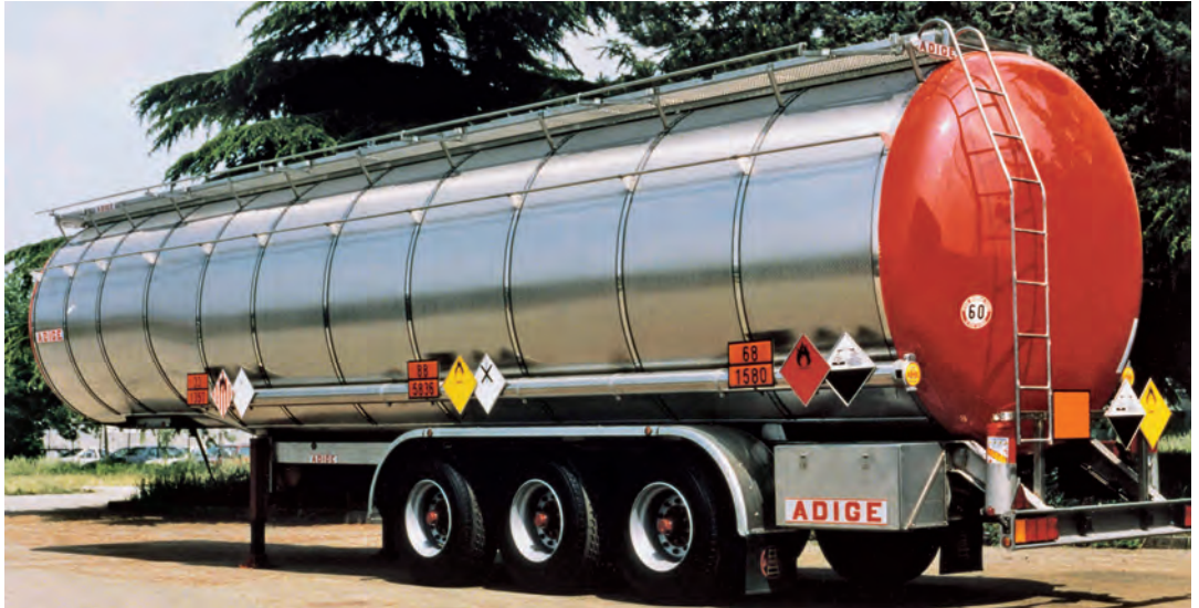
Serbatoio per l'autotrasporto di asfalto in lean duplex (Fonte: Outokumpu)
