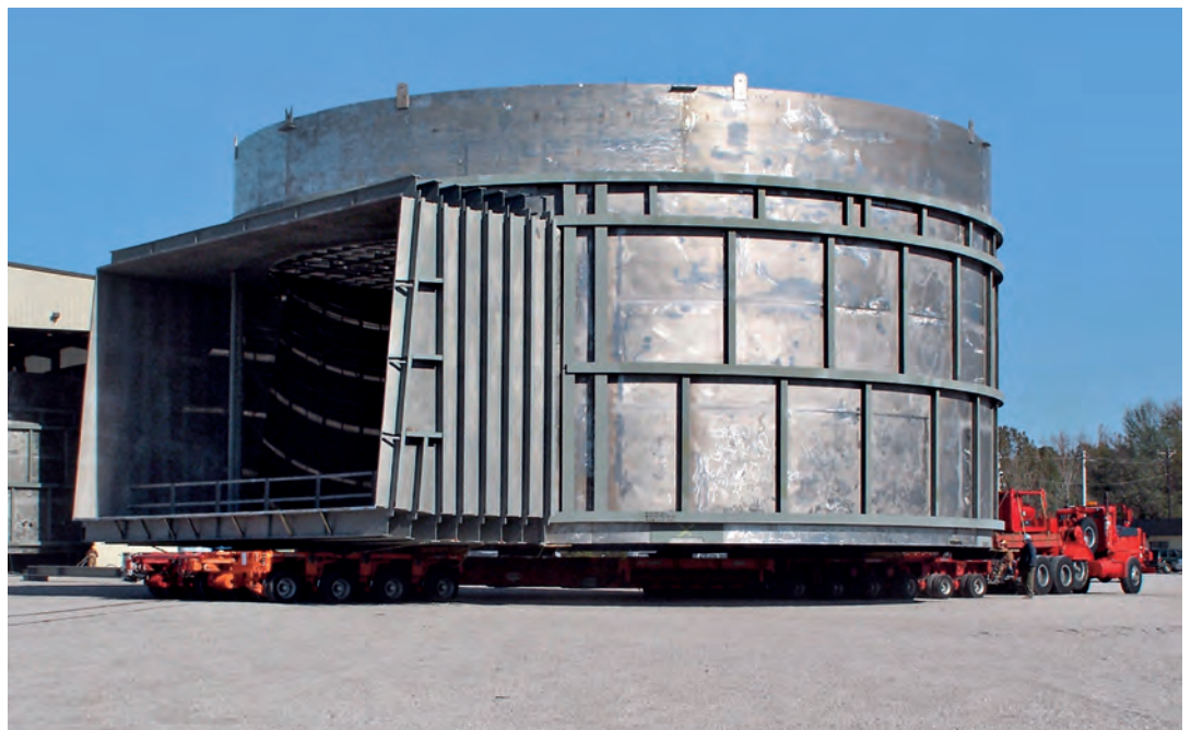
Unità di desolfurazione di gas di scarico costruita con acciaio duplex EN 1.4462 (2205) (Fonte: Aperam)
