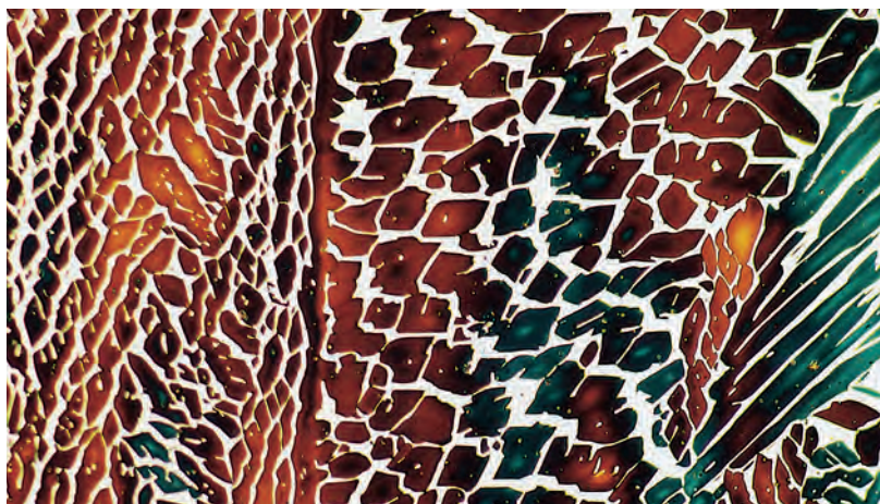
Struttura metallografica della zona fusa, acciaio EN 1.4462 (2205), 500× (Fonte: Lincoln Smitweld bv)
