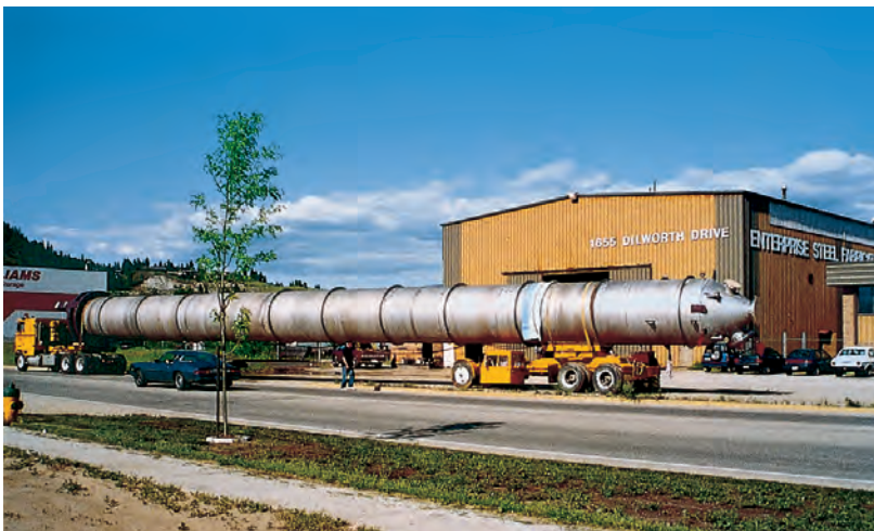
Reattore per delignificazione in EN 1.4462 (2205), Enterprise Steel Fab, Kalowna, Prince George, British Columbia, Canada (Fonte: Outokumpu)
