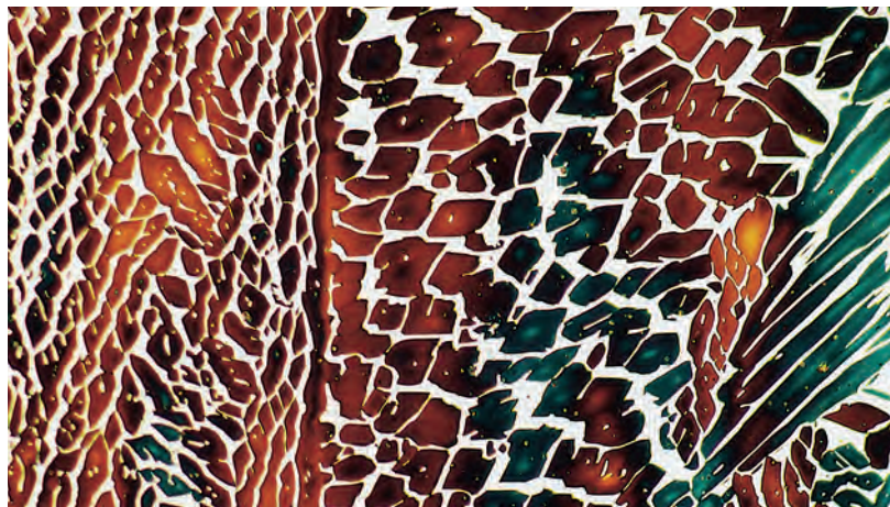
Estructura metalográfica de metal de soldadura dúplex EN 1.4462 (2205), 500x (Fuente: Lincoln Smitweld bv)
