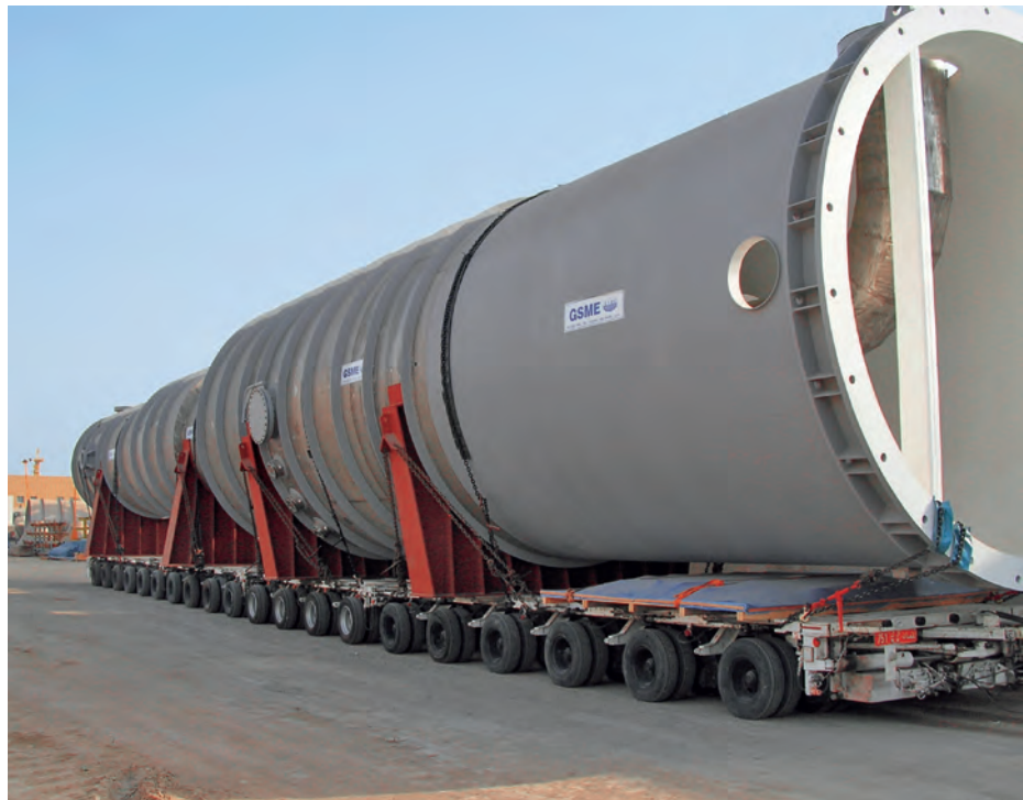
Evaporador de película descendente de acero inoxidable EN 1.4410 (2507) (Fuente: Gary Carinci, TMR Stainless)
