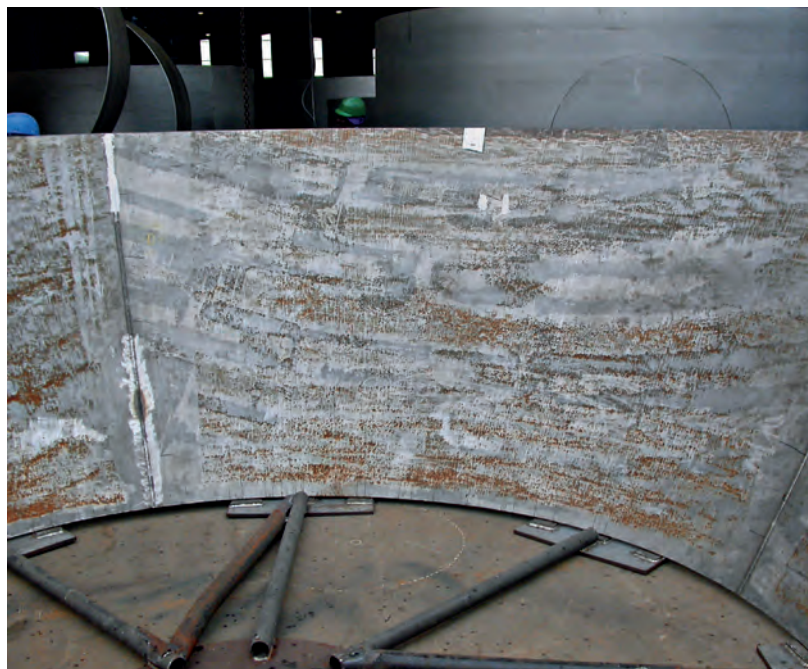
Hierro atrapado en el cilindrado de una chapa de acero inoxidable dúplex EN 1.4462 (2205) (Fuente: Gary Carinci, TMR Stainless)
