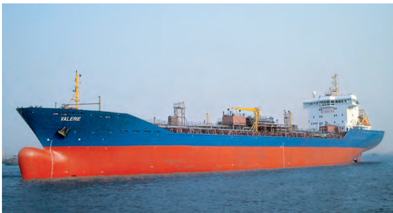
Buque cisterna para productos químicos con depósitos de acero EN 1.4462 (2205) (Fuente: Aperam)
