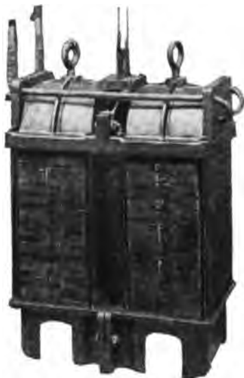
TWO THOUSAND VOLT TRANSFORMER.
