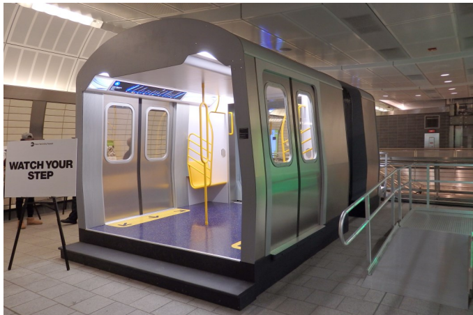
Open gangway module.
