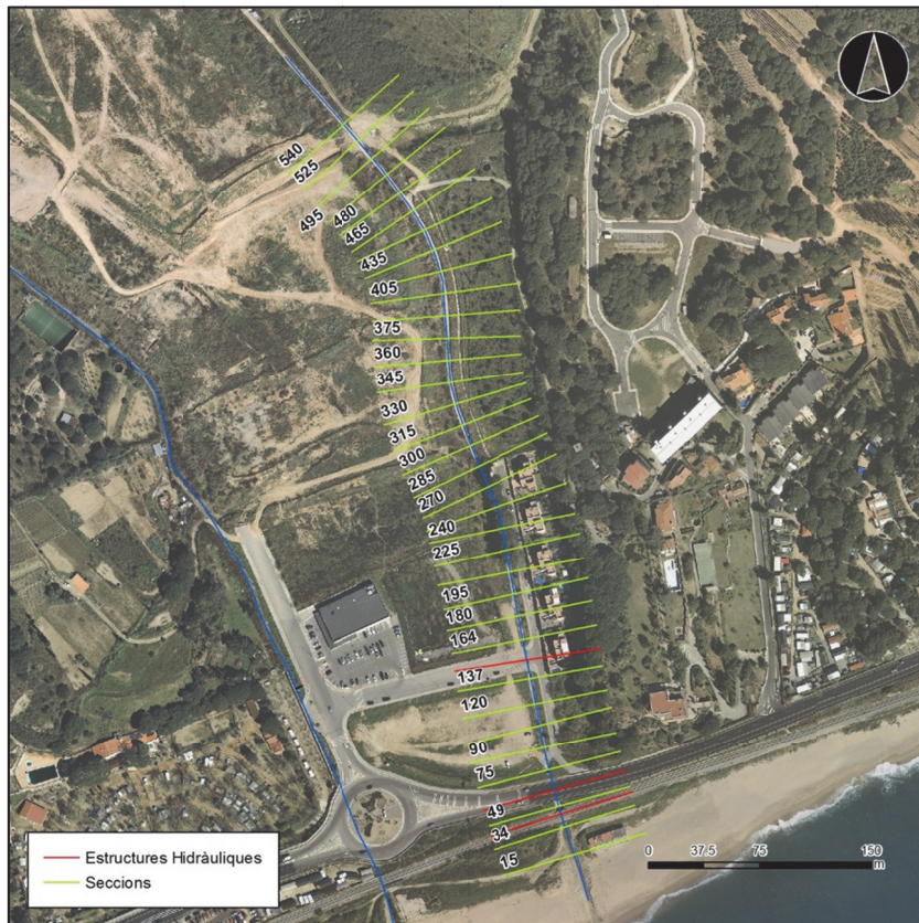
Figura 101. Posició en planta de les seccions de càlcul del rial de Can Segarres. Ortofotografies 25 cm (ICC)
