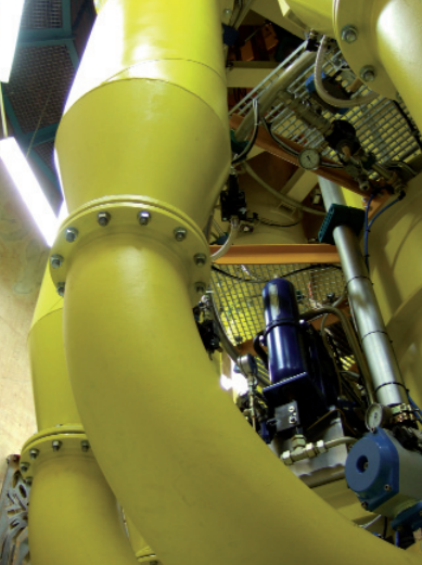
▲ Abbildung 6 Drucktanks des ZARM- Katapultsystems
