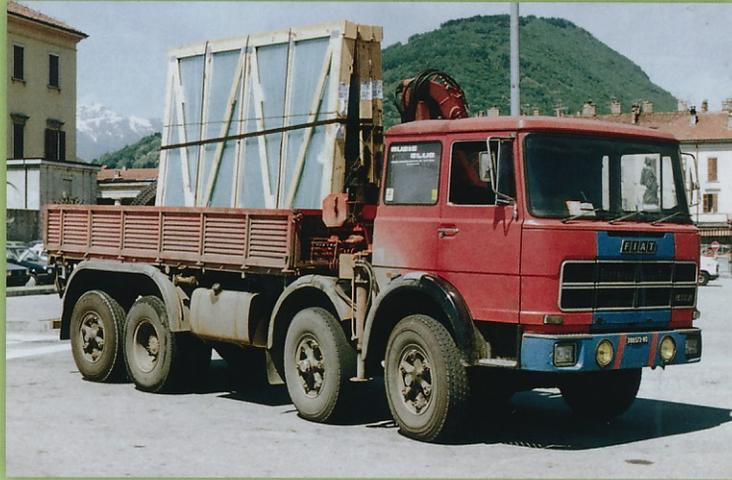
Solange noch zulässig, wurde der 691 N-Nachfolger 180 NC im Fernverkehr als 44t-Tausendfüßler eingesetzt. Er war aber auch als vierachsiges Baufahrzeug beliebt. Der 6-Zylinder-Reihenmotor 8220, leistete 260 PS. Hier ein 180 NC (8x2) von 1974, Foto Werner Hartung
