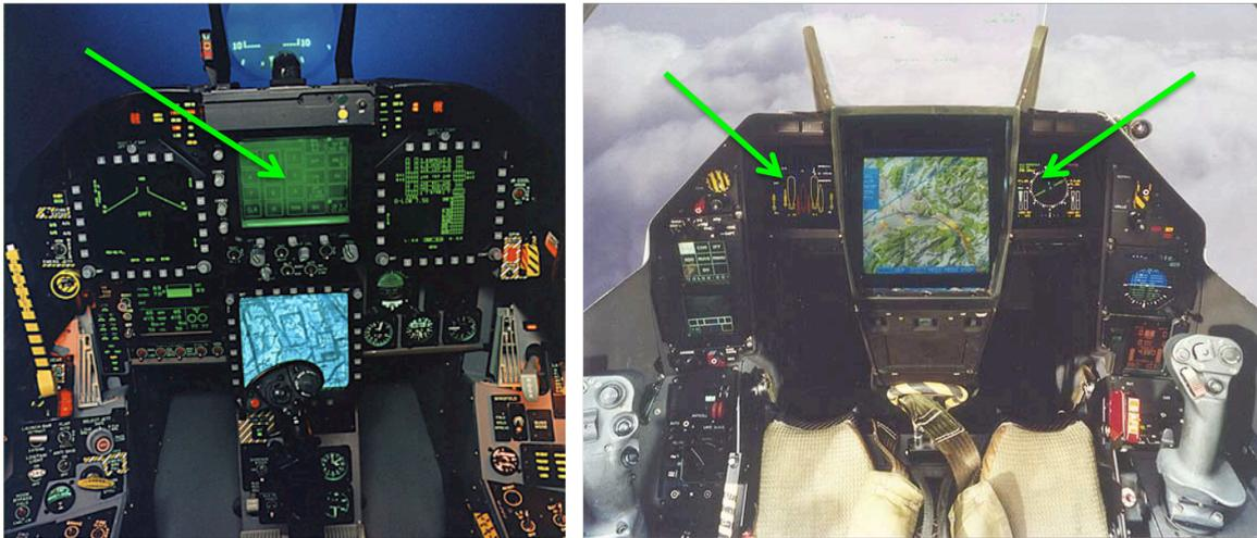
Abb. 2-7: Touchscreengeräte in aktuellen Flugzeugcockpits. Im linken Bild (Hoener & Hardy, 1999) ist der Touchscreen im Cockpit der F-18 dargestellt (grüner Pfeil). Im rechten Bild sind die beiden seitlichen MFDs mit Touchscreen-Funktion im Cockpit des Dassault Rafale (Net Resources International, 2009c) zu sehen (grüne Pfeile).
