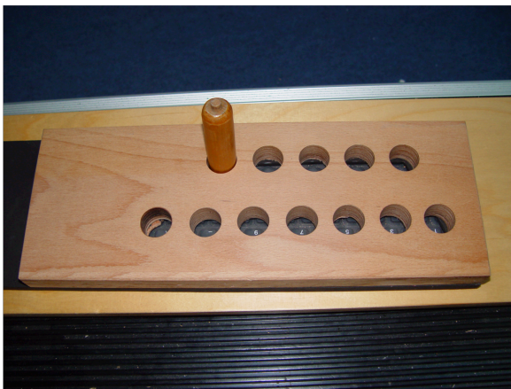
Abb. 4-6: Motorische Aufgabe. Aufgabe der Versuchspersonen ist es, den Griffel im Uhrzeigersinn ohne visuelle Unterstützung nacheinander in die Bohrungen im Matrizenbrett zu positionieren. Die Schwierigkeit der Aufgabe wird durch Größe von Bohrung und Griffel und dem Radius der Griffelober- bzw. -unterkante beeinflusst.
