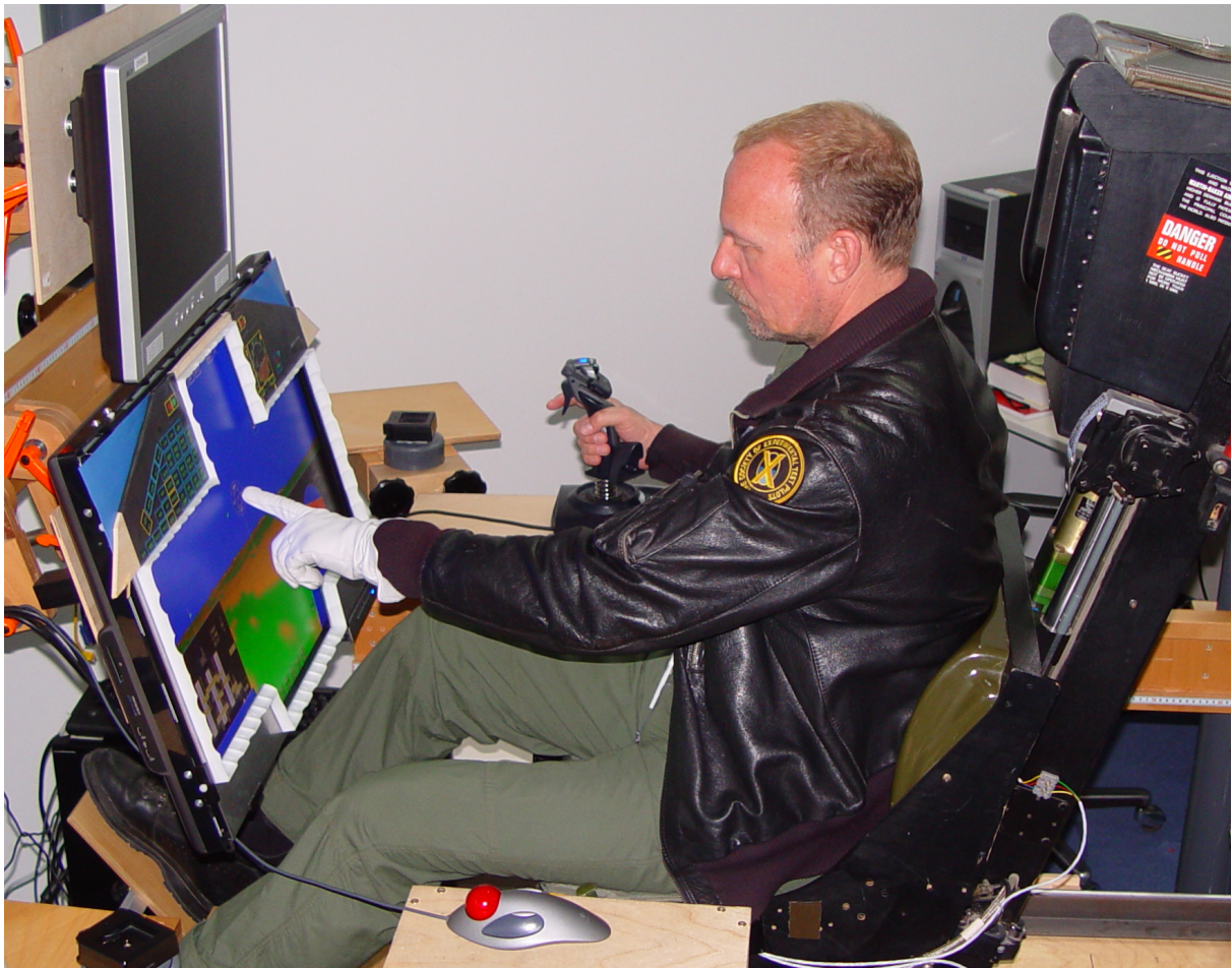
Abb. 4-10: Mock-Up mit den Anzeigegeräten Großflächendisplay und Head-Up-Display und den Bediengeräten Trackball, Touchscreen und Joystick. An der Position des Joysticks wurden je nach Zusatzaufgabe die Bedienelemente Lochbrett oder Tastatur befestigt. Touchscreen und Trackball wurden mit den im Eurofighter verwendeten Pilotenhandschuhen bedient. Touchscreen und Rahmenleiste sind in die Gerätestruktur des Großflächendisplays integriert.
