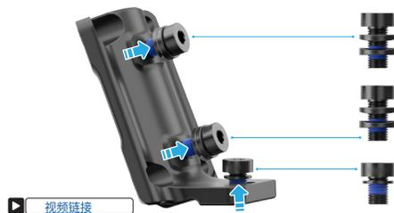
1. 前货架的三个安装螺栓将预先装配到头管面板上,在装配前必须拆除。注意每个螺栓的位置和每个螺栓上的垫圈。这些必须在相同的位置和方向上重新装配起来。
