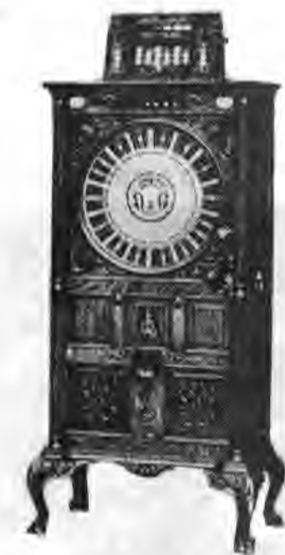
1901年の「ミルズ・シカゴ」。硬貨投入後ハンドルで円盤を回す。円盤が止った位置で勝ち負けが決まる。ウエイのとはくマシンだ。
