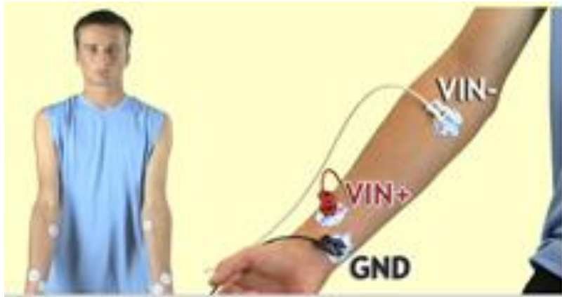
Figura 4.2.- Ubicación de Electrodo para calibración y mediciones
