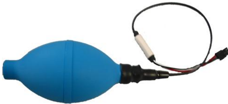
Figura 4.3.- Sistema utilizado para la medición de la fuerza de agarre
