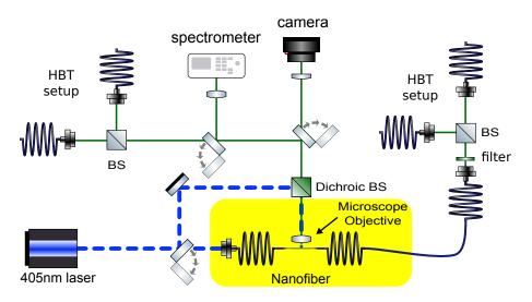
FIGURE R.22: Montage pour l'étude d'un émetteur sur une nanofibre : le laser pulsé bleu peut exciter le nanoémetteur par la nanofibre ou par l'espace libre. L'image peut être prise par la caméra, le spectre et le g<sup>(2)</sup> peuvent entre mesurés soit en espace libre soit en utilisant la lumière émise directement dans la fibre. BS : diviseur de faisceaux non polariseur, HBT : Hanbury Brown and Twiss.
