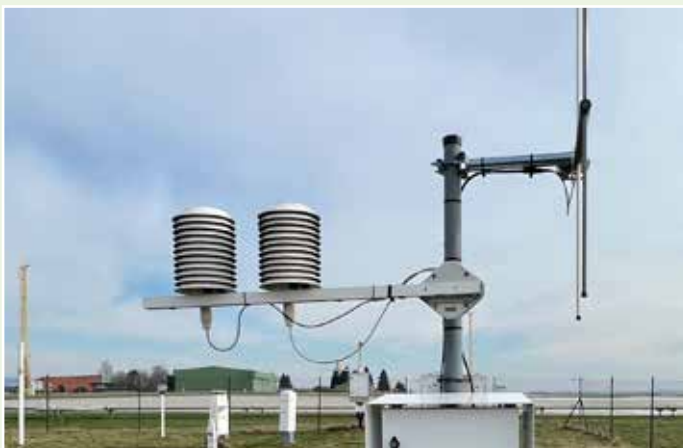
Kombinované senzory relativní vlhkosti a teploty vzduchu HMP155 v radiačním štítu DTR13
