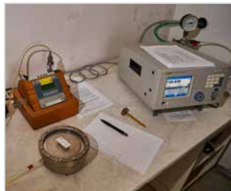
Obr. 20 Konvenční analogové aneroidy (vlevo) a digitální barometrické senzory (vpravo) a jejich kalibrace
