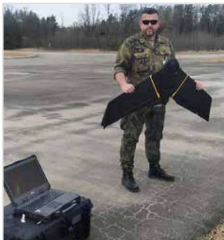
Obr. 17 K pořizování dat jsou využívány bezpilotní prostředky vybavené fotogrammetrickými senzory
