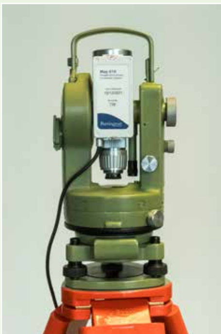
Nemagnetický teodolit Wild T-1 se sondou Bartington MAG-01H
