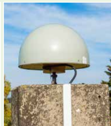
Referenční stanice GNSS Trimble Alloy a anténa Trimble GNSS Ti-V2 Choke Ring
