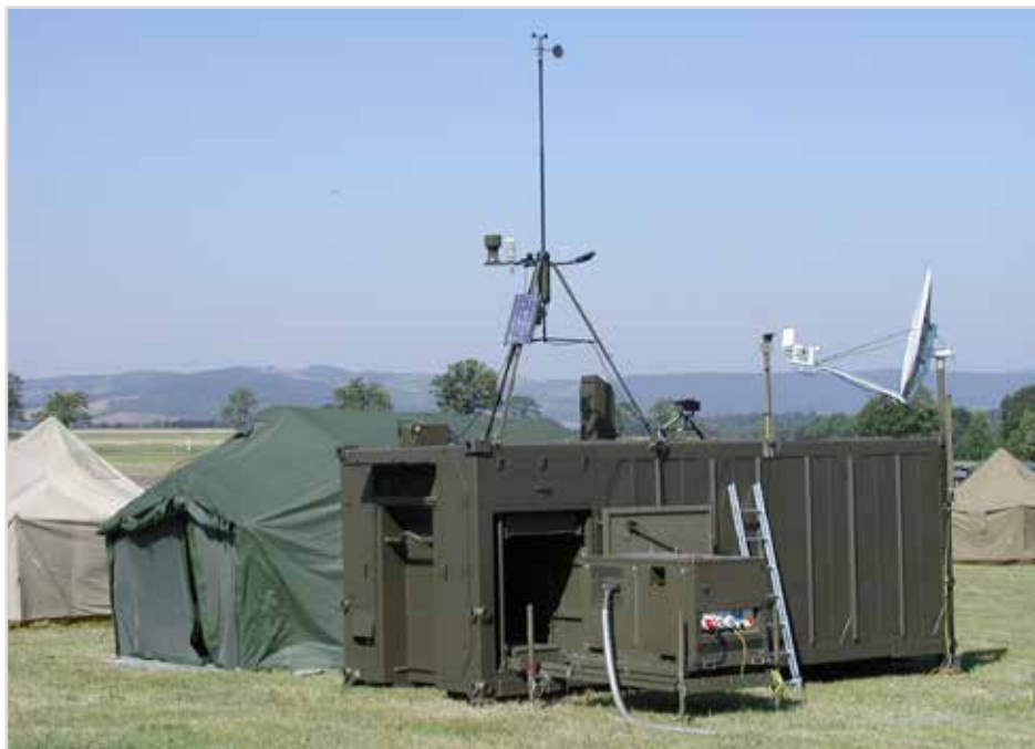
Obr. 23 Mobilní hydrometeorologická stanice Oblak (kontejner) se stanovým přístřeškem; v popředí elektrocentrála, na střeše automatická stanice MAWS 201M TacMet
