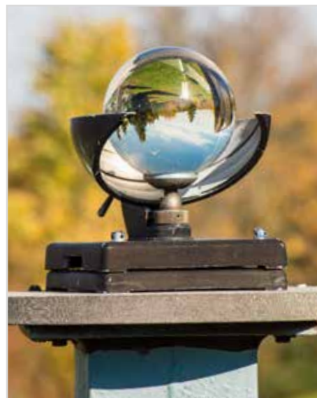
Obr. 23 Pro měření slunečního svitu jsou využívány elektronické slunoměry (nahore); klasické heliografy dnes zůstávají na meteorologických stanicích jako symbolická připomínka starých časů (dole)
