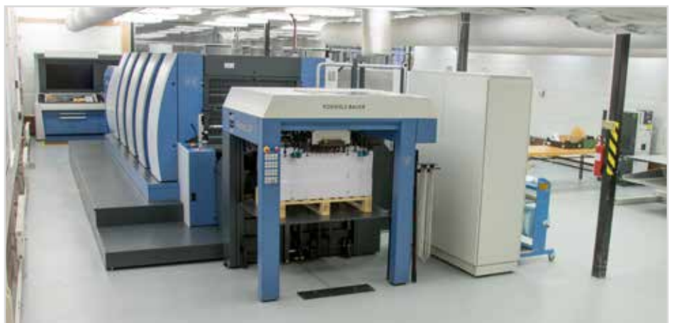
Obr. 28 Ofsetový tiskový stroj KBA Rapida 106-5 FAPC
