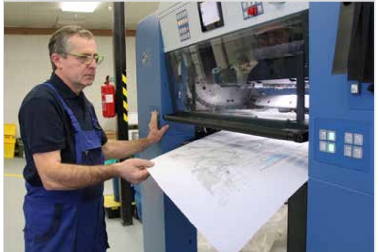
Obr. 25 Pro polygrafické zpracování kartografických děl je využíván ofsetový tiskový stroj Rapida 106-5 FAPC firmy Koenig & Bauer
