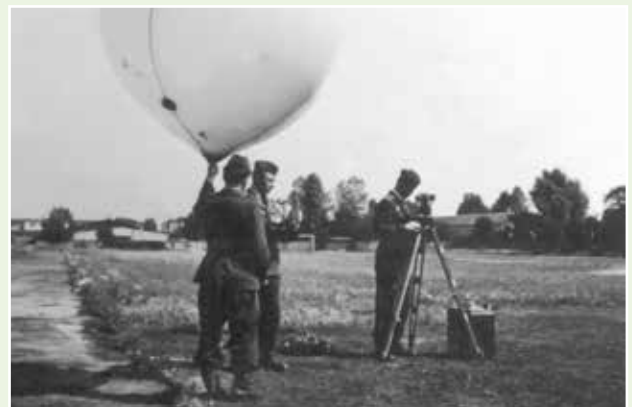
Příprava výškového měření pomocí jednopilotáže v 50. letech dvacátého století
