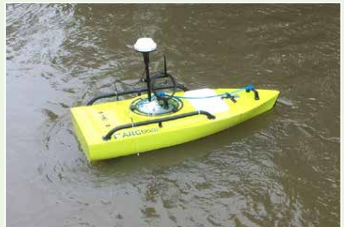
Dálkově ovládaný člun ArcBoat Lite s měřicím systémem SonTek RiverSurveyor® S5
