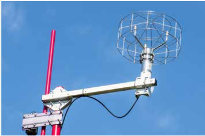
Ultrasonický senzor rychlosti a směru větru WMT703 s ochranou proti ptactvu
