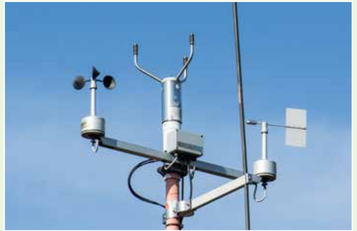
Senzor rychlosti větru WAA151 (vlevo), ultrasonický senzor rychlosti a směru větru WS425 (uprostřed) a senzor směru větru WAV151
