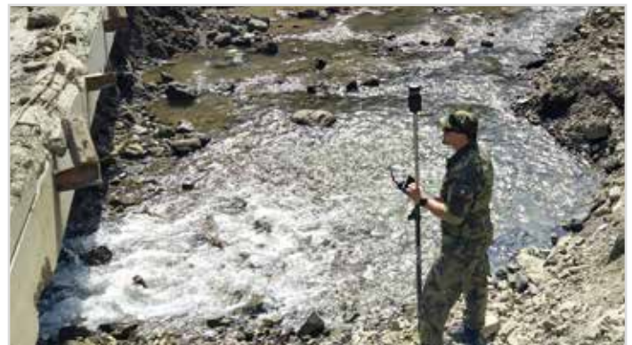
Obr. 1 Terestrické měření přijímačem GNSS (npor. Ing. L. Morávek)
