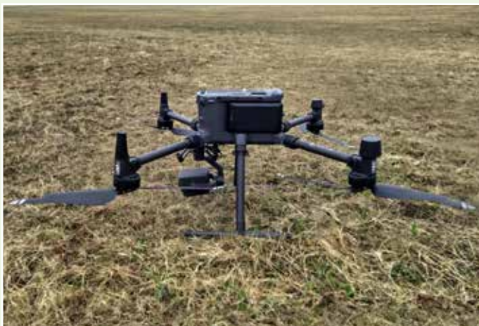
Bezpilotní prostředek DJI Matrice 300 RTK vybavený kamerou DJI Zenmuse H20
