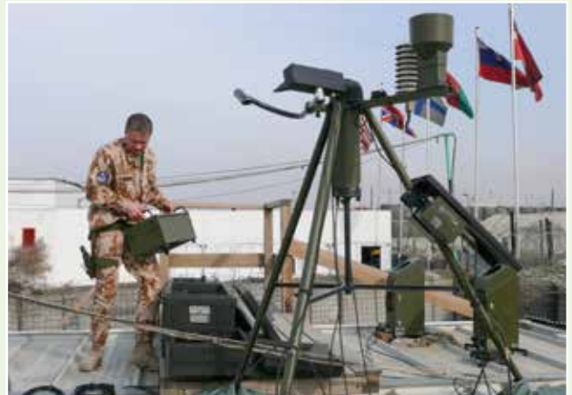
Příprava automatické povětrnostní stanice MAWS 201 TacMet při hydrometeorologickém zabezpečení zahraničních operací
