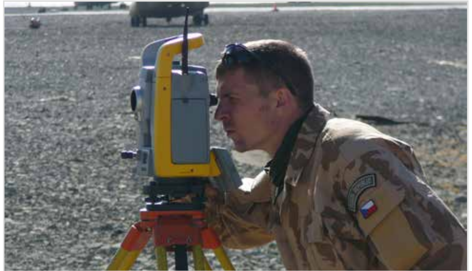
Obr. 47 Měření kompenzačního kruhu pro vrtulníkovou jednotku v Afghánistánu
