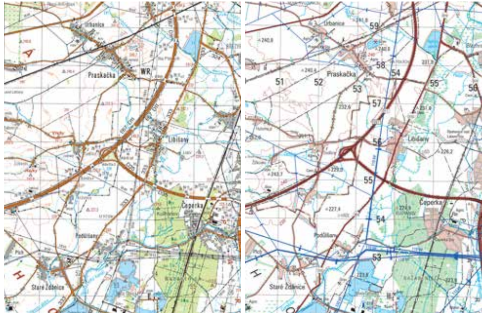
Obr. 11 Porovnání obsahu současné topografické mapy v měřítku 1 : 50 000 (vlevo) a nového typu topografické mapy stejného měřítko (vpravo) zpracované plně podle specifikací NATO
