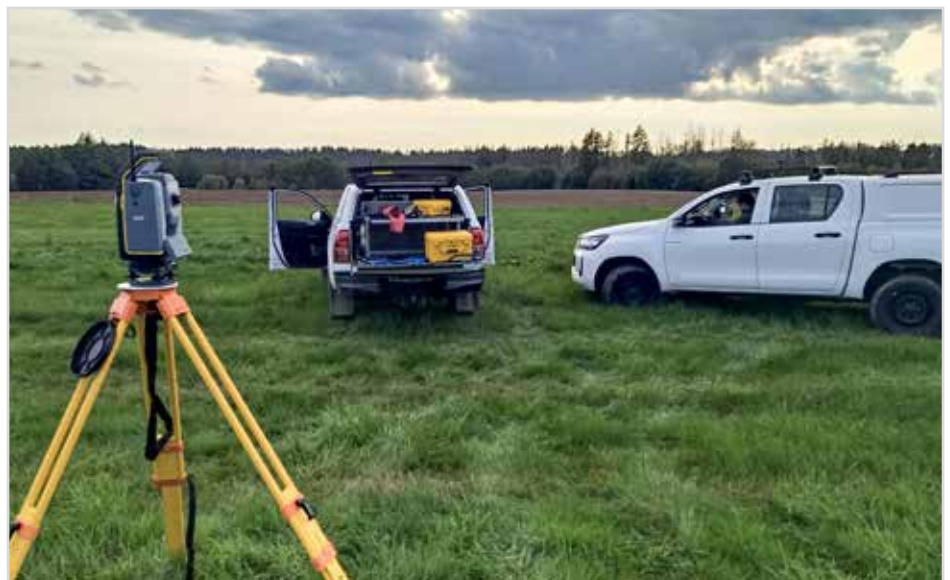
Obr. 8 Pro geodetické práce byl vyvinut modul geodeticko-topografické soupravy GeToS vytvořený přestavbou terénního vozidla Toyota Hilux
