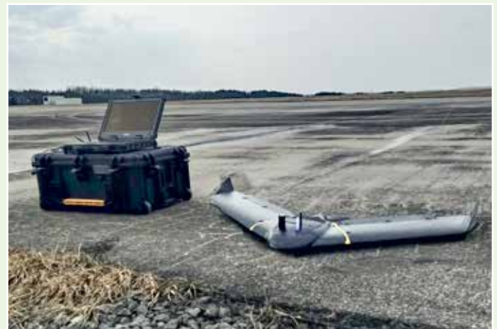
Bezpilotní prostředek senseFly eBee X s integrovanou kamerou senseFly Aeria X
