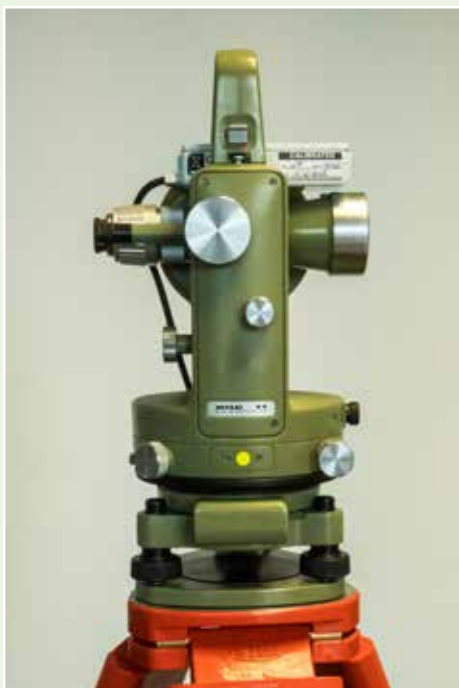
Nemagnetický teodolit Wild T-1 se sondou Bartington MAG-01H
