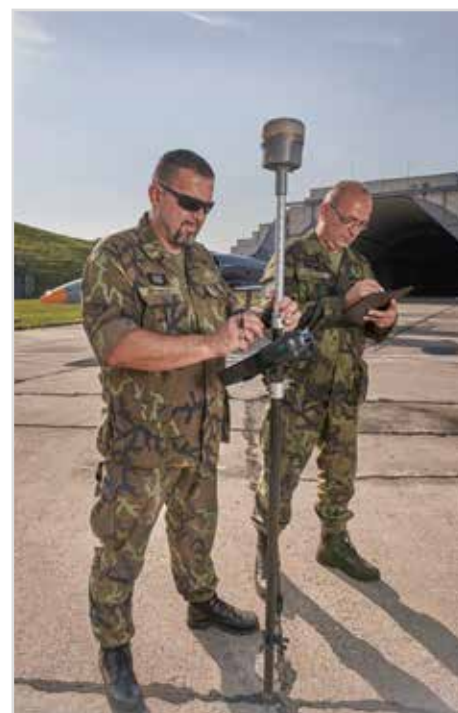
Obr. 2 Měření přijímačem globálních navigačních družicových systémů Trimble R10 [foto: Ing. Josef Musil]
