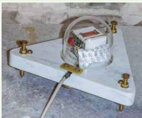
Senzor pro měření velmi slabých magnetických polí
