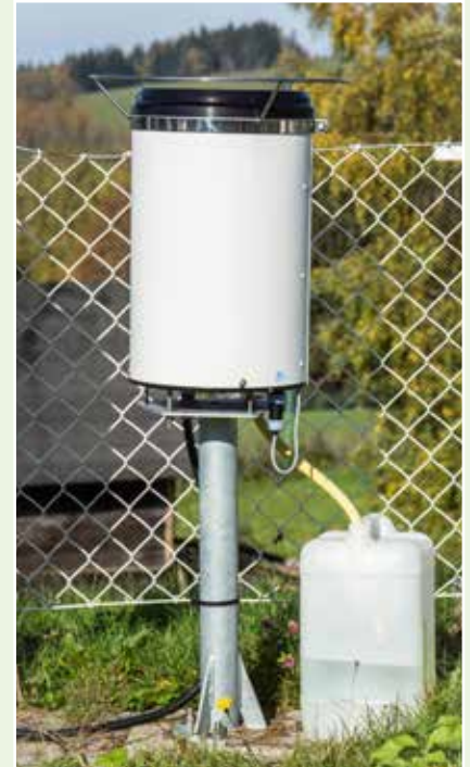
Tenzní srážkoměr MW-7
