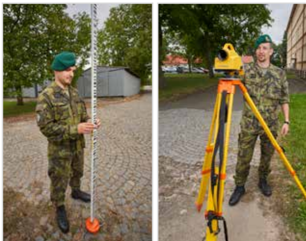
Obr. 9 Měření nivelačním přístrojem Trimble DiNi 03 [foto: Ing. Josef Musil]
