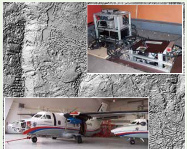
Při leteckém laserovém skenování v rámci projektu tvorby nového výškopisu ČR v letech 2009 až 2015 byl systém LiteMapper 6800 umístěn na palubě letounu Turbolet L-410 FG
