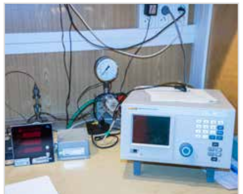
Obr. 20 Konvenční analogové aneroidy (vlevo) a digitální barometrické senzory (vpravo) a jejich kalibrace
