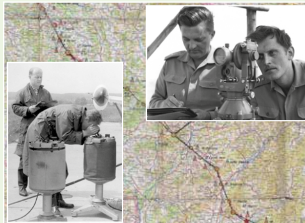
Gravimetr Askania GS-12 (vlevo) a teodolit Wild T3 (vpravo) používané vojenskými geodety na konci 60. let dvacátého století při zaměření Základny kosmické triangulace
