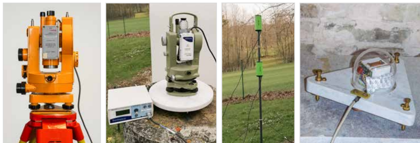
Obr. 12 Magnetometrické přístroje – zleva nemagnetické teodolity Zeiss Theo O15B a Wild T-1 se sondou Bartington MAG-01H, jednoosý protonový magnetometr PNG-1 a senzor pro měření velmi slabých magnetických polí vyvinutý na Českém vysokém učení technickém
