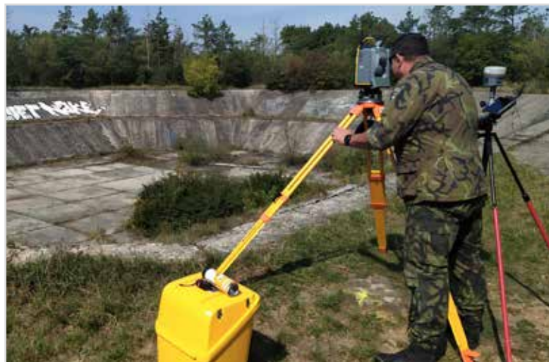
Obr. 10 Měření totální stanicí Trimble S6
