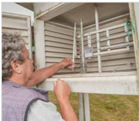
Obr. 16 Analogová čidla měření teploty a vlhkosti v meteorologické budce [foto: Ing. Josef Musil]
