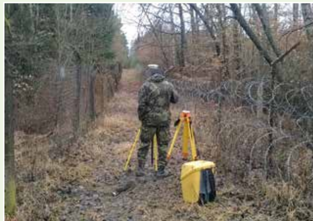
Geodetické práce při zaměření průběhu oplocení a vytýčení prostor pro pyrotechnickou očistu v muničním skladu ve Vrbětčích (2015)
