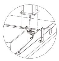
Inserisci l'esagono della colonnatesta lungo la scanalatura di guida conl'estremità cablata rivolta verso il motore.
