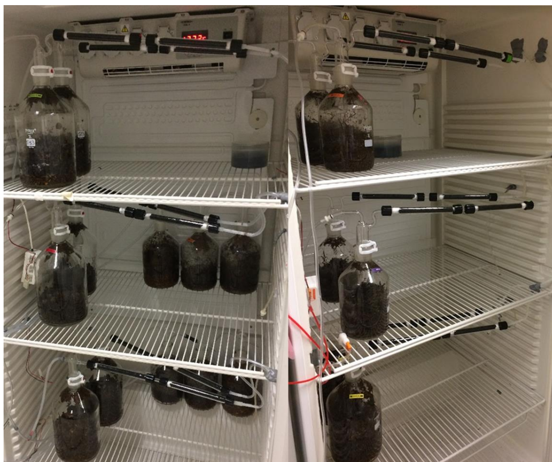
Figure chap4 - 2 : Chambres d'incubation à 28°C avec 6 flacons contenant les humus non dopés et 12 flacons contenant les humus dopés avec ^{125}\text{I} équipés de pièges à charbon actif pour l'iode 125 volatil.
