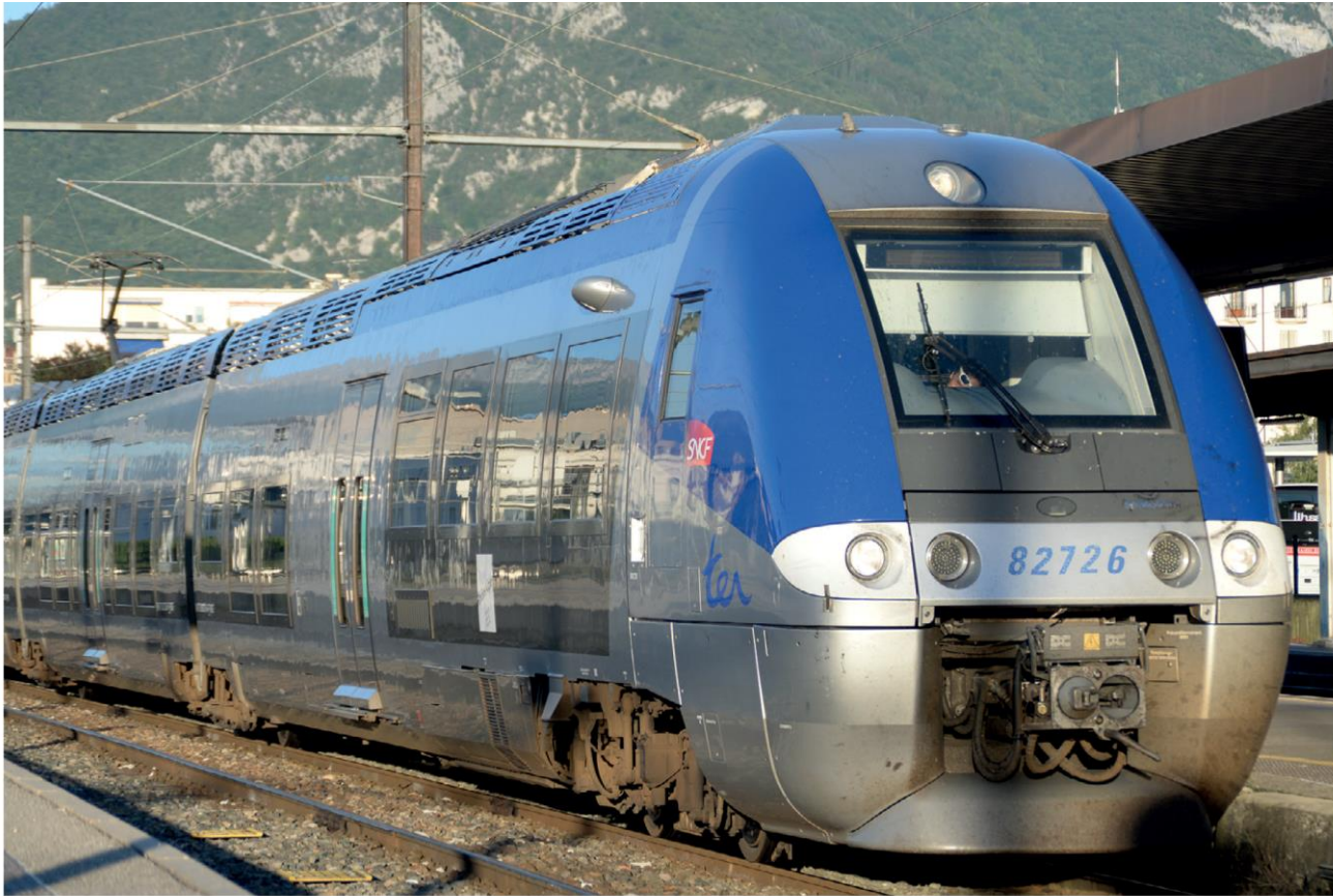
Abb. 3: Zweisystem-Zweikrafttriebzug BB 82500 der SNCF in Annecy
