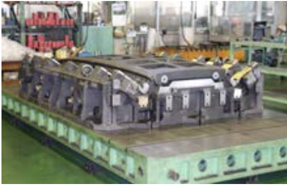
ロータリーカムを組み込んだ金型
