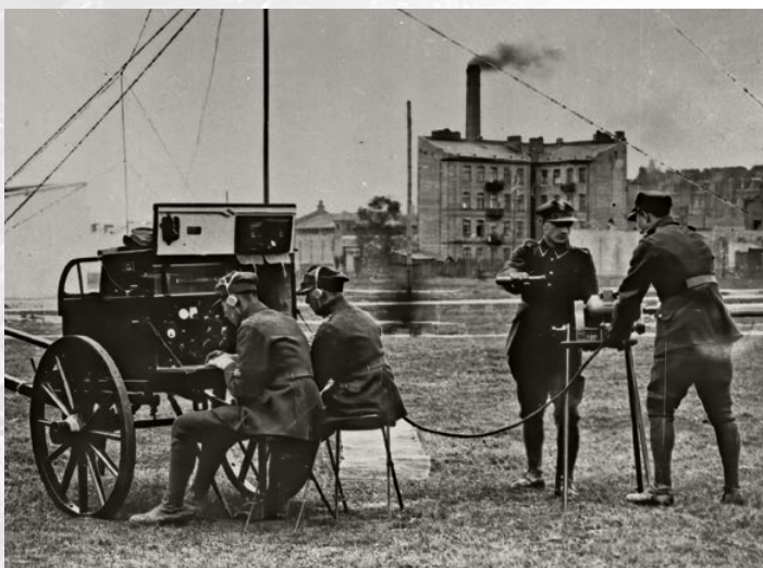
Radiostacja dywizyjna E-10 na dwukółkach. Z prawej widoczna prądnicą ręczną obsługiwana przez dwóch żołnierzy
