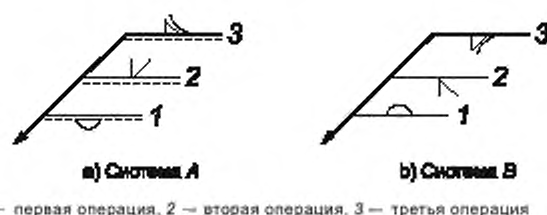
Рисунок 5 — Примеры обозначений сварного соединения для поверхности соединения указанной стрелкой и обратной стороны
