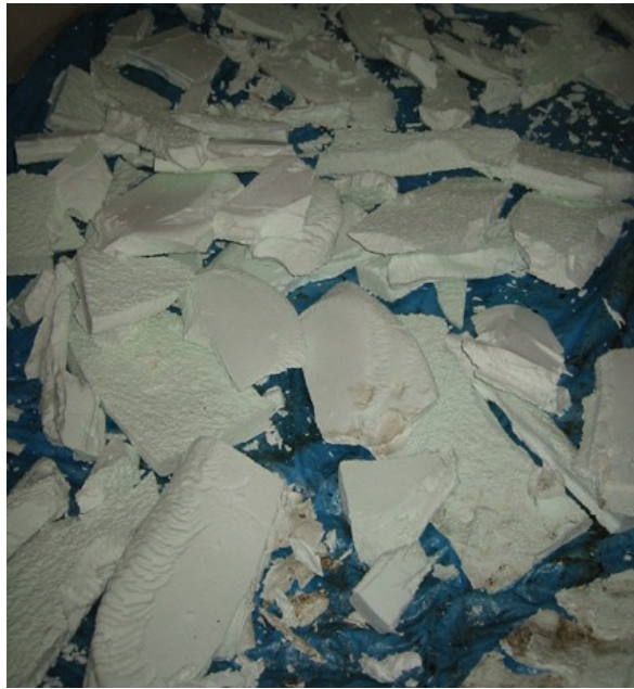
図 重機による分離断熱材片
